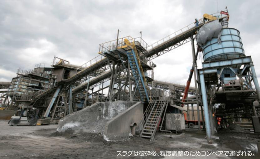
スラグは破碎後、粒度調整のためコンベアで運ばれる。
