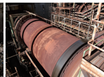
▼ 廃棄物はホッパーからロータリーキルンに送られ、雑芥・廃油を焼却する。排熱は蒸気として回収、リサイクルされる。
