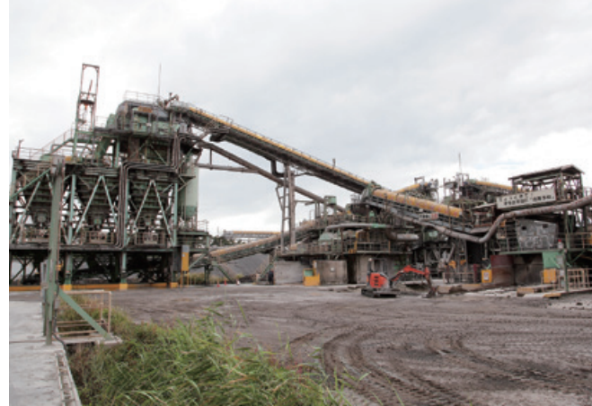
▲ サイジングプラントで破碎されたスラグの粒度を整える。
