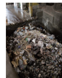
▼ 廃棄物はホッパーからロータリーキルンに送られ、雑芥・廃油を焼却する。排熱は蒸気として回収、リサイクルされる。
