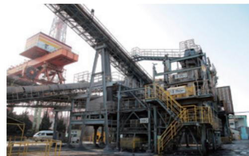
▼ 工場内に集積される廃コンクリート。鉄鋼スラグと混合し、再生路盤材として利用される(小倉)。
